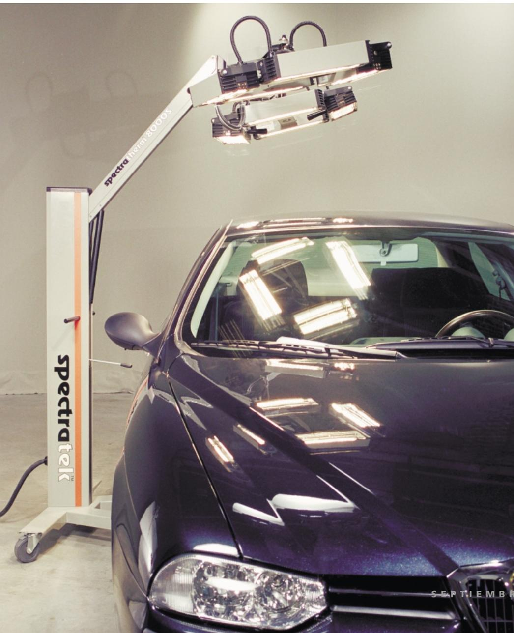
La aparición en el mercado de equipos de secado por infrarrojos de onda corta de nueva generación ha posibilitado su uso en ciertas aplicaciones dentro del taller de reparación de automóviles. El equipo de secado por infrarrojos Spectratherm 8000S es una herramienta portátil de sencillo manejo, sin renunciar a un riguroso control de la energía calorífica aportada.
