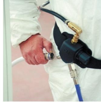
Detalle del conjunto regulador de conexiones rápidas.
