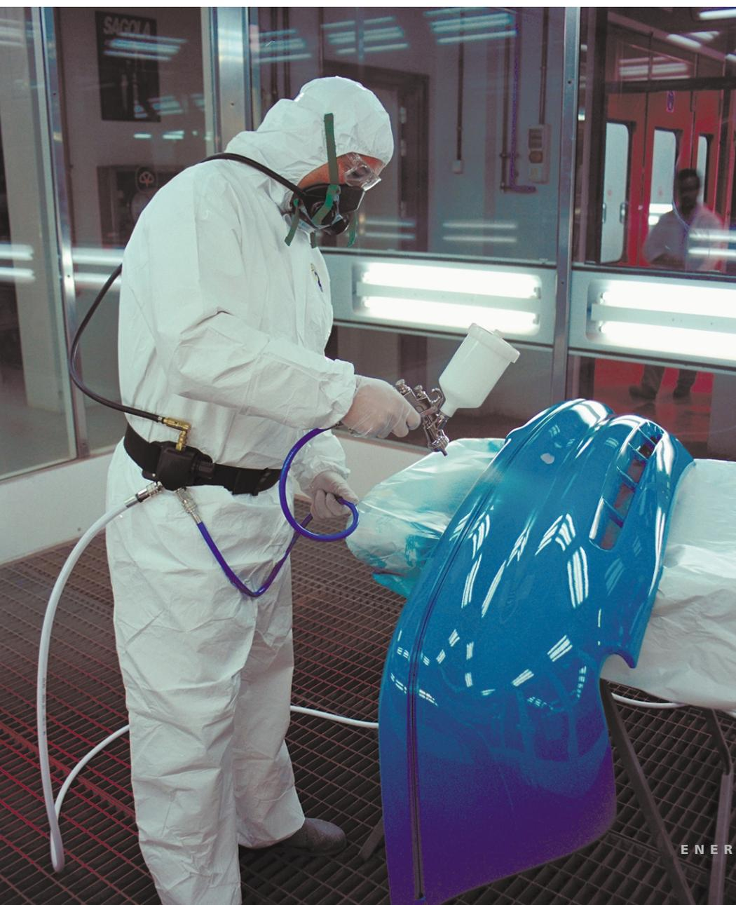
En el área de pintura es imprescindible utilizar elementos que aíslan las vías respiratorias de vapores tóxicos y partículas nocivas. El sistema respirador S-200 de 3M, alimentado mediante la red de aire comprimido, cumple esta función protectora, permitiendo, además acoplar en él filtros de carbono activo, que actúan en aquellos momentos en los que el equipo respirador está desconectado de la instalación de aire comprimido.
